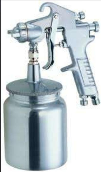
تعتمد طريقة الرش من حيث الجانب الميكانيكي على مبدأ عمل فيزيائي بالأساس ، إذ تعتمد على ضغط الهواء لتحويل المحلول الزجاجي الى رذاذ وذلك بضغط الهواء بواسطة ضغط المكبس ودخول الهواء إلى داخل خزان المسدس و لاختلاف الضغط الهوائي سيتم مزج الهواء بالسائل الزجاجي فيتحول إلى رذاذ يتدفق الرذاذ الناعم جدا من فتحة موجودة في فوهة المسدس ، ويوجه الرذاذ إلى سطح القطع الفخارية ليلتصق بالقطع ويشكل طلاء متجانس السمك له .
